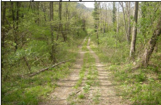
Potek trase po gozdni poti po položnem delu terena, (območje obsežnejšega starega plazu – v mirovanju). Pobočje pokriva deluvij – flišna preperina (glina in zaglinjen grušč).
